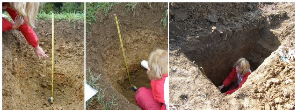
Obr. 16 Výkop půdní sondy s určením mocností horizontů a přítomnosti karbonátů
